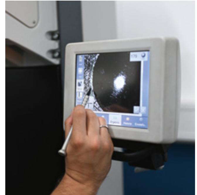
Die geforderten Hrtewerte werden mit geeigneten Hrteprfgerten in HV bzw. HB ermittelt und attestiert.
