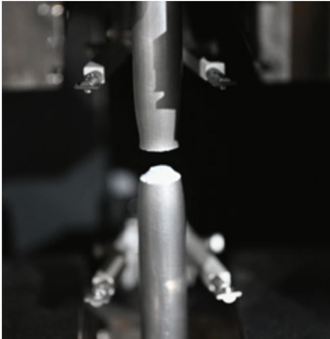
Mit einer 400 kN-Zerreimaschine werden in unserem Hause bei allen unseren Produkten Festigkeits- und Dehnungswerte ermittelt und attestiert.
