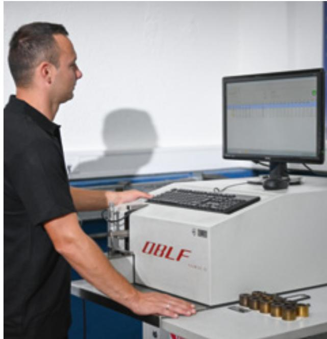
Von jeder Fertigung in unserem Haus werden Proben genommen. Diese werden mittels eines Emissions-Spektrometers auf ihre chemische Analyse (bis zu 20 Werkstoff kennzeichnende Elemente) mit der eingesetzten sowie der geforderten Qualitt verglichen und dokumentiert. Somit ist eine genaue Chargenzuordnung sichergestellt.
